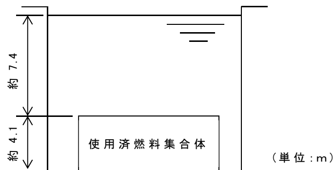
図1.2 燃料有効長頂部から水面までの水位
