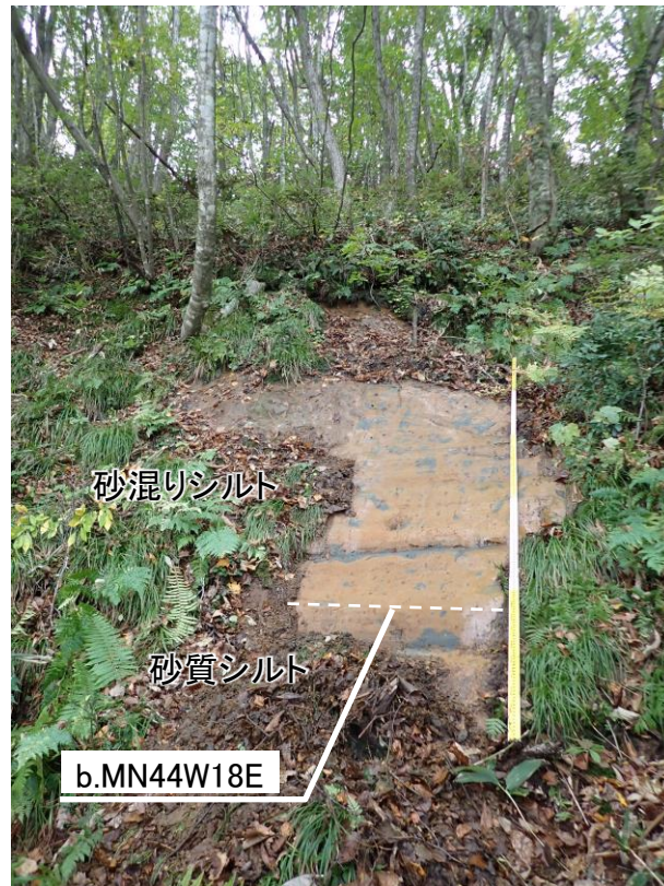
写真w 標高22~27m付近にみられる六ヶ所層(R) ・六ヶ所層(R)は、砂混りシルトと砂質シルトからなる。
