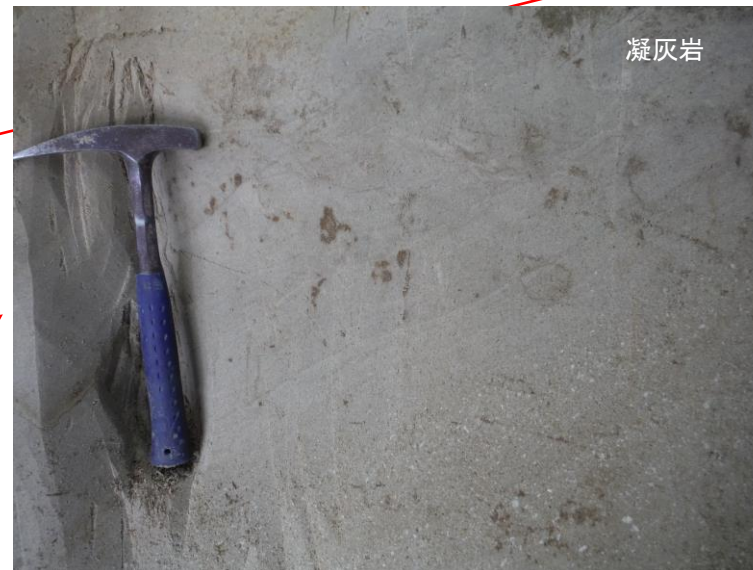
↑ Tkh露頭: 砂子又層下部層(S1)の標高22m付近に認められる凝灰岩【Tkh-T_01_f.a試料】
