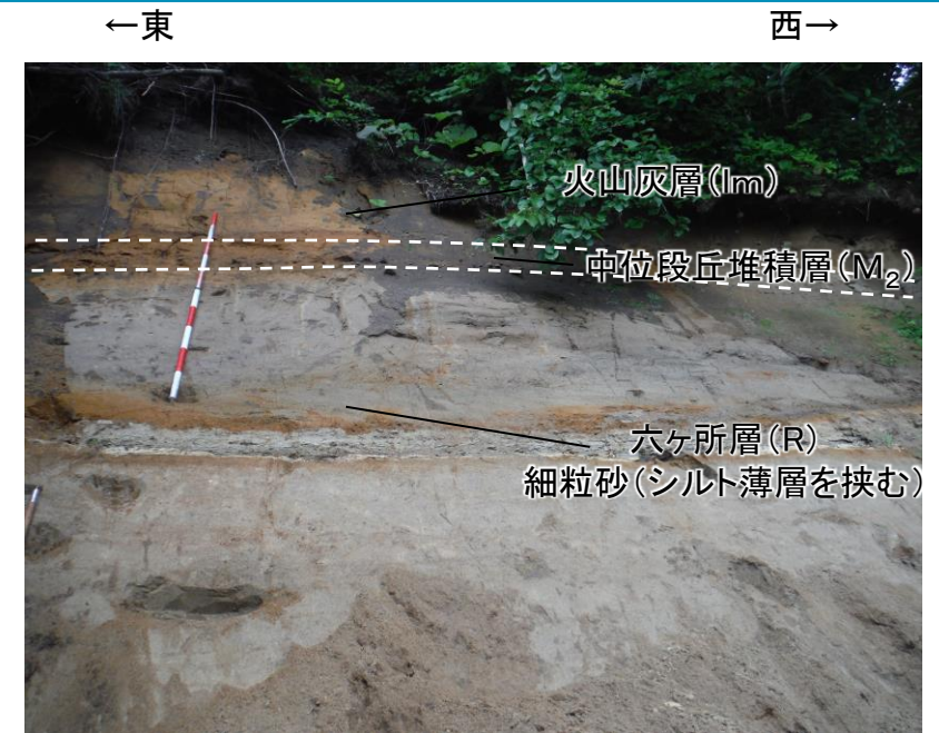
写真g 標高20m付近にみられる六ヶ所層(R)と中位段丘堆積層(M 2 )の不整合面 ・中位段丘堆積層(M 2 )は扁平礫を伴う砂からなる。 ・六ヶ所層(R)は細粒砂からなり、シルト薄層を挟む。
