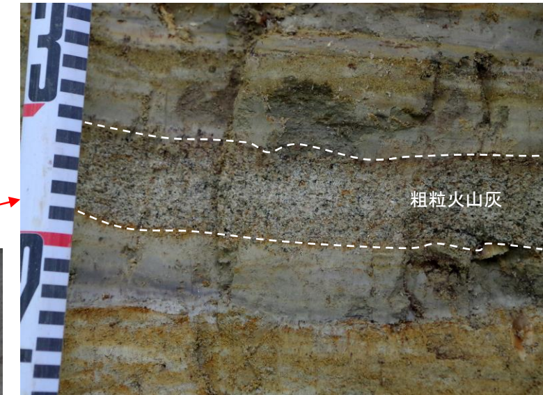
↑ Tkh露頭: 砂子又層上部層(S3)(非海成層)の基底付近(標高26.5m付近)に認められる粗粒火山灰【Tkh-S_01.c.a試料】
