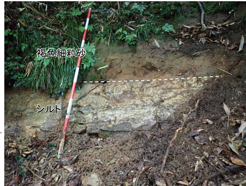
写真a 標高30~35m付近にみられる六ヶ所層(R) ・褐色細粒砂とシルトからなる。 ・層相境界は6° 南に傾斜している。
