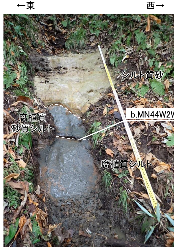
写真r 標高15m付近にみられる六ヶ所層(R) ・六ヶ所層(R)は、シルト質砂～腐植質シルトからなる。
