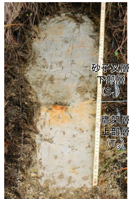
写真k 標高約25mにみられる鷹架層上部層(T 3 )と砂子又層下部層(S 1 )の不整合面 ・鷹架層上部層(T 3 )はシルト岩からなる。 ・砂子又層下部層(S 1 )は中粒砂岩からなる。
