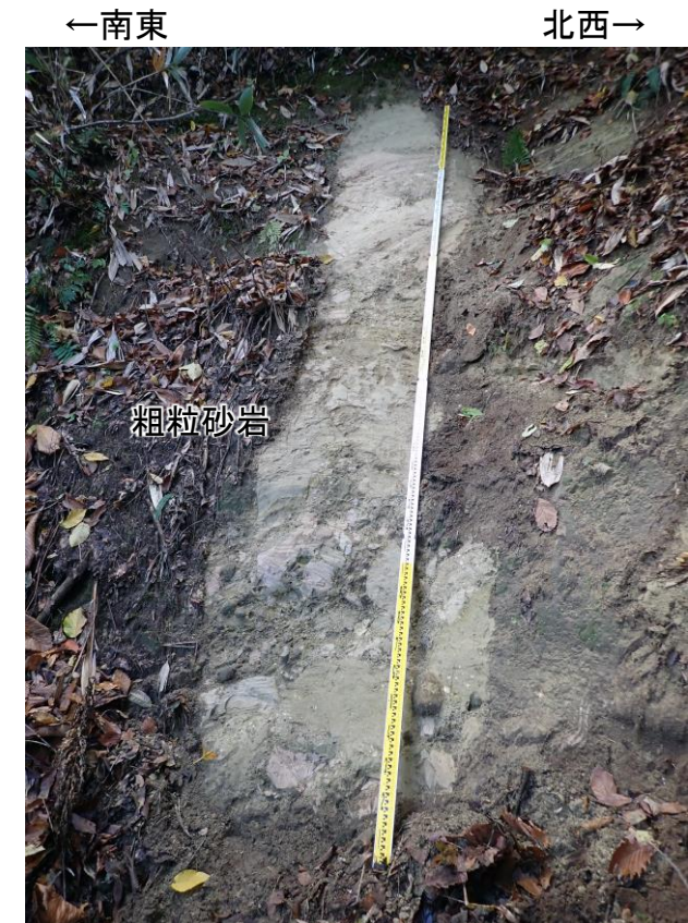
写真m 標高10～15m付近にみられる砂子又層下部層(S 1 ) ・砂子又層下部層(S 1 )は、粗粒砂岩からなり、礫岩を挟む。
