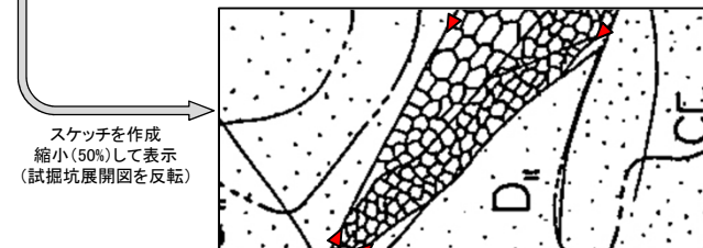
3号炉試掘坑2坑北西壁で確認したTF-5断層(上:写真, 下:スケッチ)
