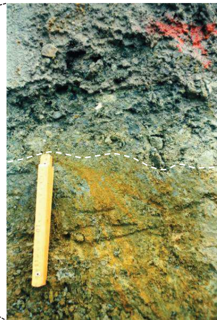
第四系基底と断層破砕帯の近接 (南側法面: 追い込み掘削前)
