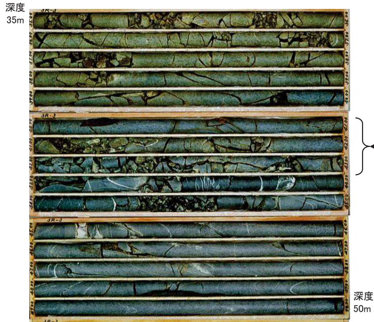
3R-3孔(ボーリングコア写真)
