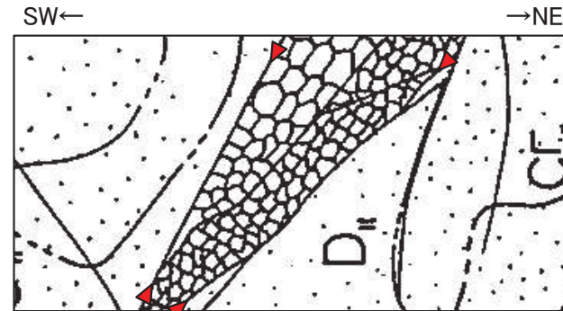
TF-5断層近傍 3号炉試掘坑2号坑北西壁スケッチ (展開図を反転)
