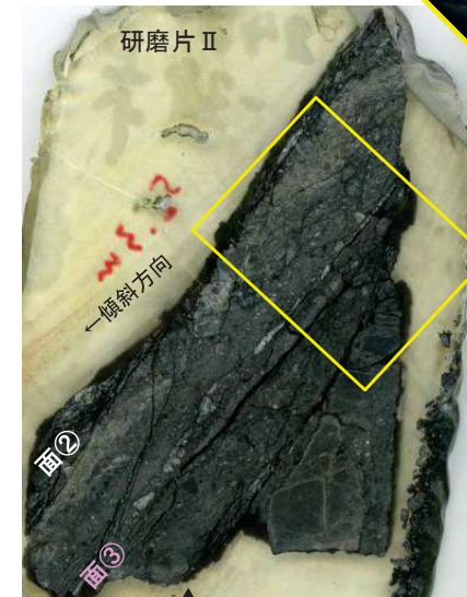
研磨片 I を紙面手前側約1cmの箇所で切断し、作成
