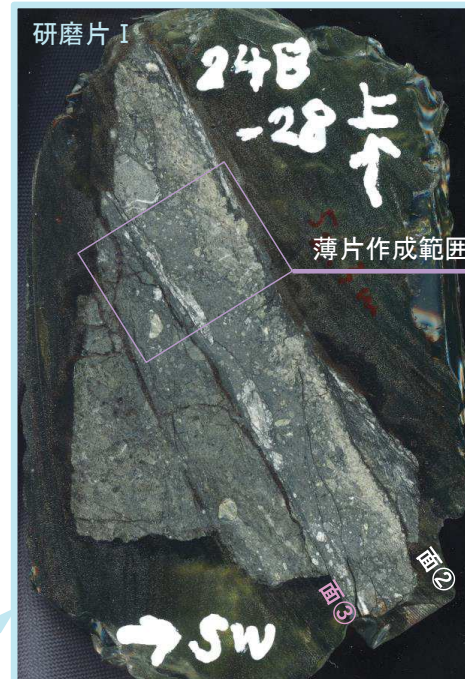
研磨片作成範囲 (コアを半割りし、手前側の試料で作成)
