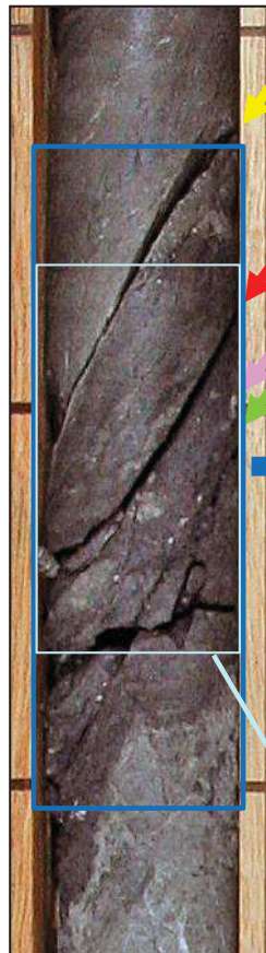
研磨片作成範囲 (コアを半割りし 手前側の試料で作成)
